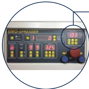
전용 디지털 조작부 (디지털 장력 조절부) Digital control panel (Digital tension control)
